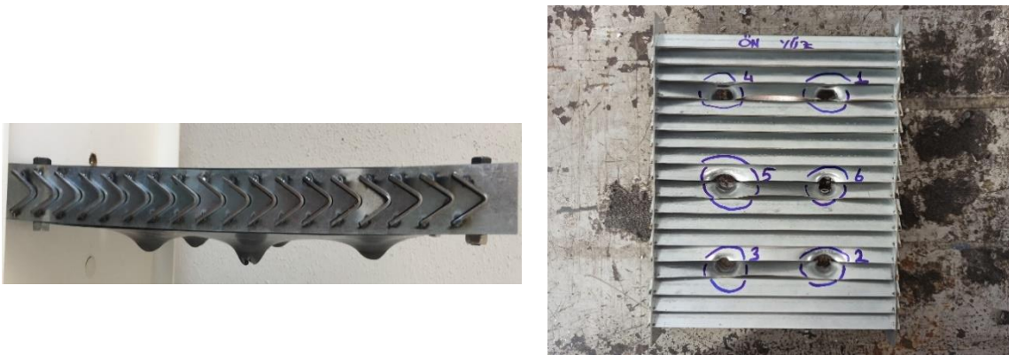
Görsel 5. Test uygulanmış zırh sisteminde iç yapının perfore- hasar görüntüleri
