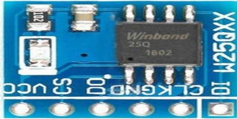
Görsel 7. W25Q32 entegreye gelen gerilimin çalışması için kullanılan direnç
