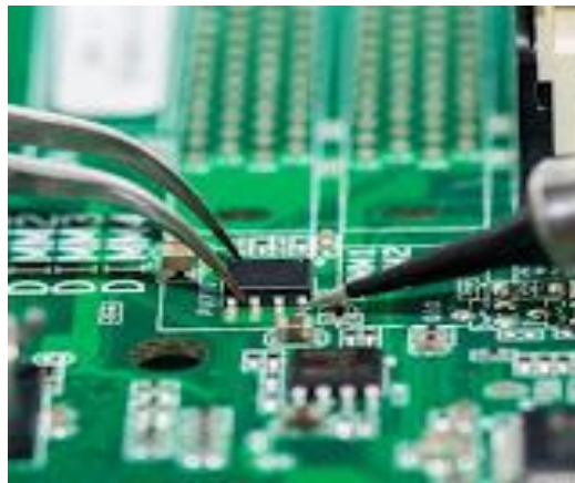
Görsel 10. Ultra HD LED televizyonun entegrenin son lehimleme işlemi
